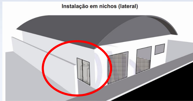
Figura G.1 – Instalação de recipientes transportáveis em nicho lateral
