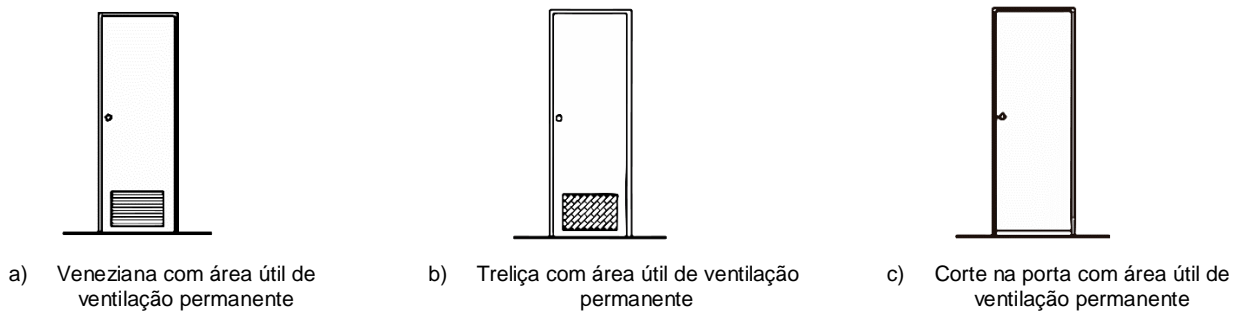
Figura C.2 – Exemplos de aberturas para ventilação inferior
