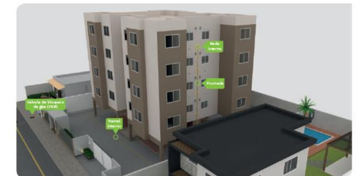
Figura 03 - Rede de Distribuição Interna
